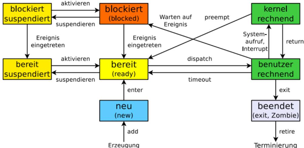
Ein **Zombie-Prozess** ist fertig abgearbeitet (via Systemaufruf `exit`), aber sein Eintrag in der Prozesstabelle existiert so lange, bis der Elternprozess den Rückgabewert (via Systemaufruf `wait`) abgefragt hat
