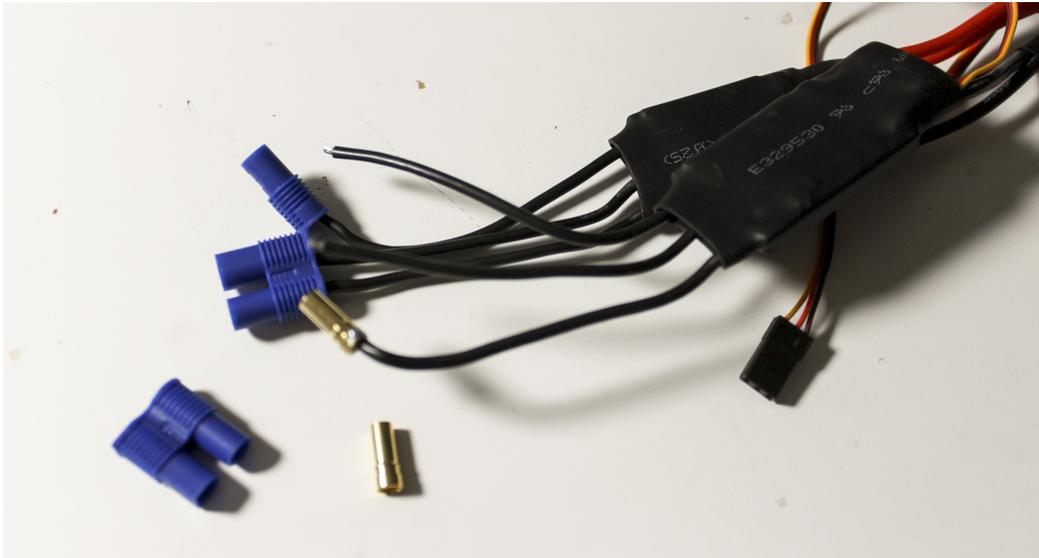
Abbildung 8.4.2: Arbeitsschritt beim Verlöten von EC3 Steckern
