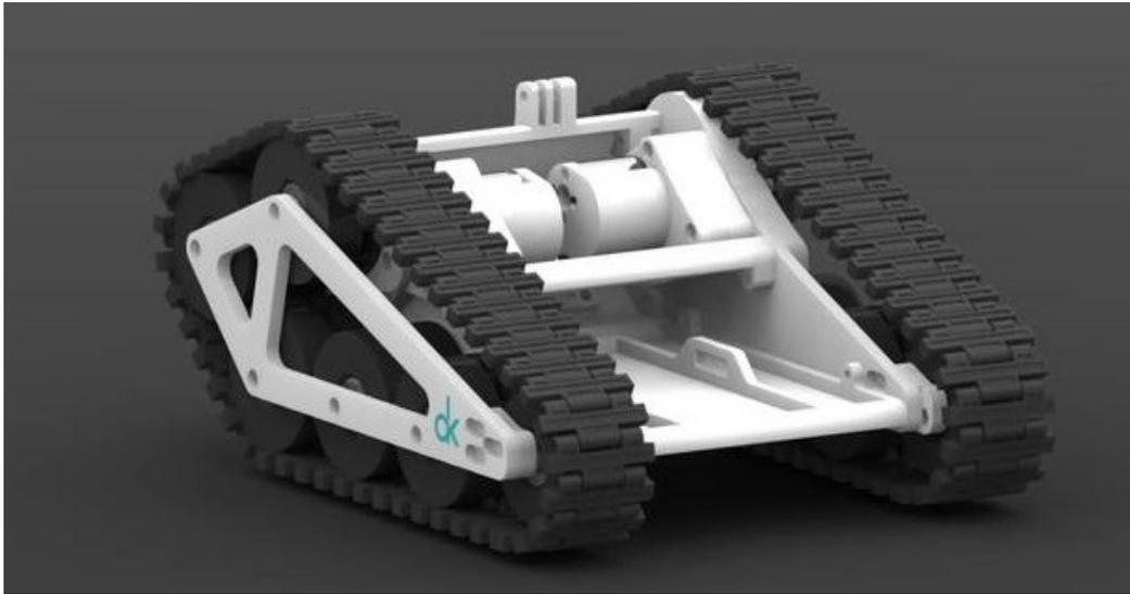
Abbildung 7.3.1: Gerendertes Bild des gewählten Kettenfahrzeugs
