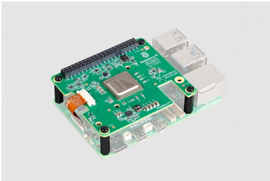
Abbildung 4: Raspberry Pi 5 mit AI-HAT+ [14]
