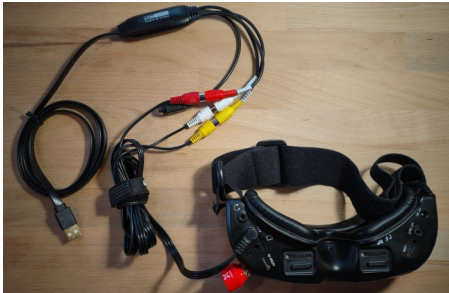
Videobrille mit angeschlossenem Videograbber, um das Livebild an einem Computer zu verarbeiten
