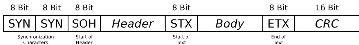
Kommen die Steuerzeichen ETX oder DLE (*Data Link Escape*) im Nutzdatenteil (*Body*) vor, müssen sie vom Protokoll der Sicherungsschicht durch ein zusätzliches DLE-Zeichen geschützt (*maskiert*) werden. Ein einzelnes ETX-Zeichen im Nutzdatenteil wird durch die Zeichenfolge DLE ETX repräsentiert. Das DLE-Zeichen selbst wird durch die Zeichenfolge DLE DLE repräsentiert.
